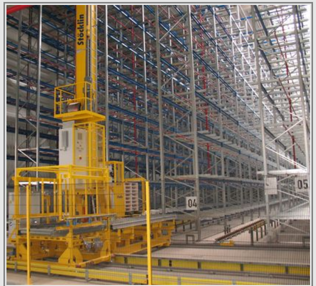
Bild: Taubert – Verfahrwagen mit RBG vor den Gassen
