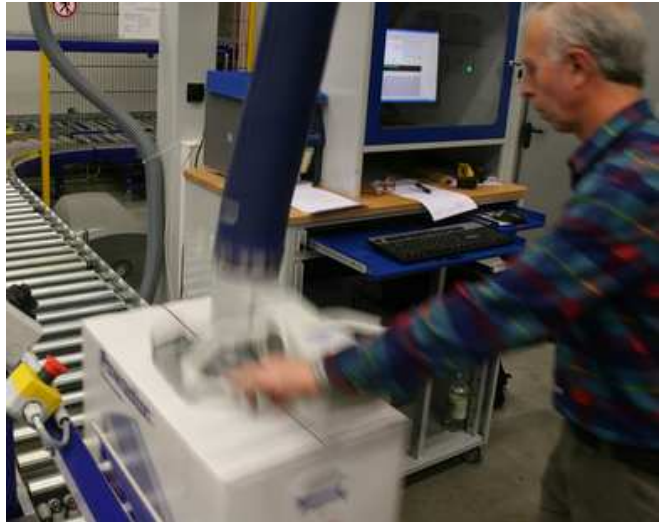
Bild 4: Hubunterstützung mit Vakuumsaugheber in der Kommissionierung
