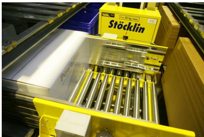
Bild 3: Kartonabgabe des Regalbediengeräts
