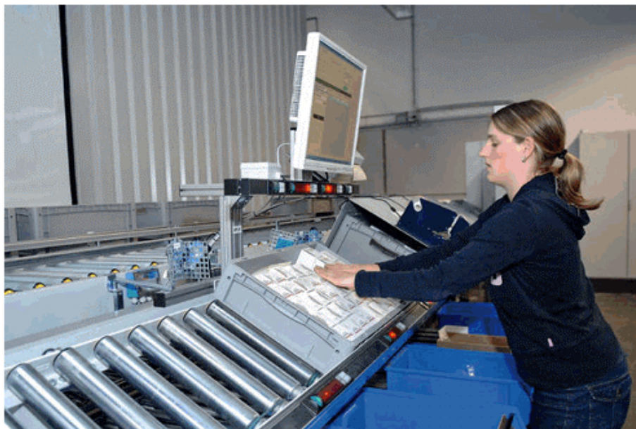
Mit einem automatisierten A-Teile-Lager mit Pick-to-light-Kommissionierung wurde der Versandbereich erweitert. Bilder: Norgren
